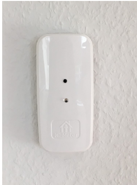
Den digitale måler fra IC-Meter, som måler indeklimaet. Foto: Domea.dk
